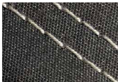
Alle naden zijn voorzien van dubbele stiksels.
