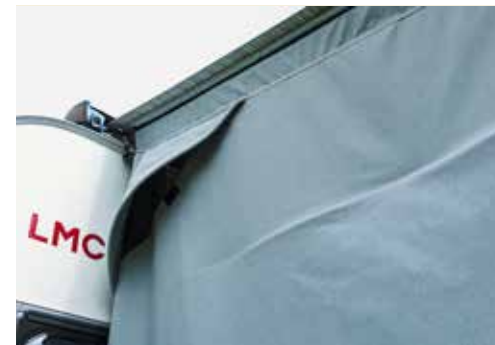
Afgedekte ventilatie in de zijwanden.
