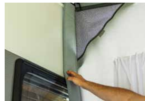
Aansluitkussen tegen het voertuig incl. aandrukstang.
